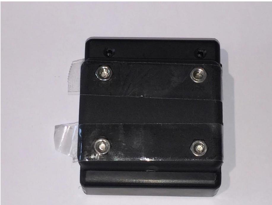
Als nächstes die Naviverlegung mit den gelieferten Schrauben auf die originale Rückenplatte schrauben:
